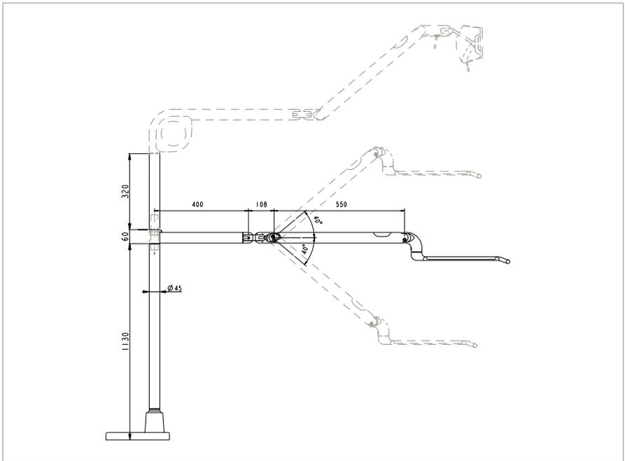
**TRAYSYSTEM MIT AUFBAUSTANGEN U. BODENADAPTION**
